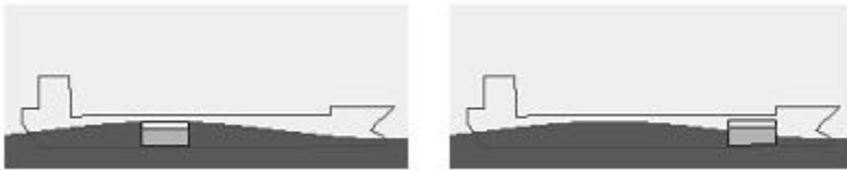
Rys. 2. Położenie ładowni uszkodzonej w czasie symulacji ruchu okrętu na fali czołowej
