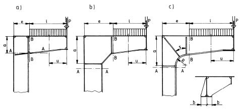
Fig. 8.3.5.1 Hatch side cantilevers
