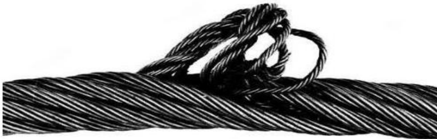
Rys. 10. Wyciśnięcie stalowego rdzenia powszechnie towarzyszące zniekształceniu koszykowatemu – uzasadnienie natychmiastowej wymiany.
