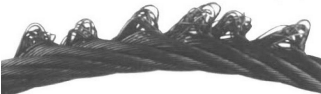
Rys. 12. Wyciśnięcie drutów w jednej splotce (stan ostry uszkodzenia z rys.11 ), typowe dla lin podnoszenia z układaczem liny – uzasadnienie natychmiastowej wymiany.
