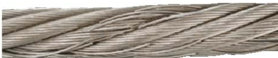
Rys. 3. Zerwane druty w jednej splotce wskutek niewielkiego zużycia liny współzwitej – możliwość dalszego użytkowania, jeżeli w innych częściach liny nie ma gorszych uszkodzeń (pęknięte druty powinny być tak obcięte, aby ich końce znalazły się we wgłębieniach między splotkami, co zabezpieczy druty sąsiednie przed ścieraniem ).
