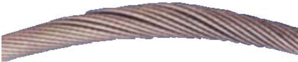
Rys. 11. Wyciśnięcie drutów w jednej splotce; badania całej liny może pokazać, że zniekształcenie jest widoczne w regularnych odstępach, normalnie w jednej splotce.
