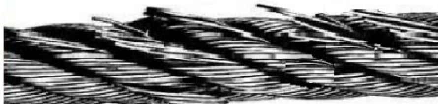
Rys. 1. Zerwane i wyciśnięte druty w sąsiednich splotkach liny przeciwwzitej – uzasadnienie wymiany.
