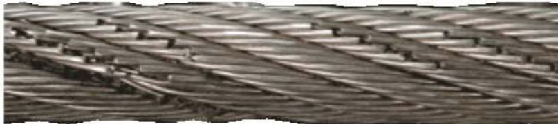
Rys. 6. Zerwane druty w dwu splotkach, występujące w krążku wyrównawczym, spowodowane unieruchomieniem krążka – uzasadnienie natychmiastowej wymiany.
