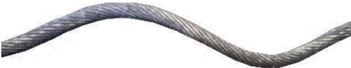
Rys. 8. Przykład falistości liny (oś wzdłużna przybiera kształt linii śrubowej). Jeżeli zniekształcenie przekroczy wartość podaną w 3.10 – lina powinna być wymieniona.
