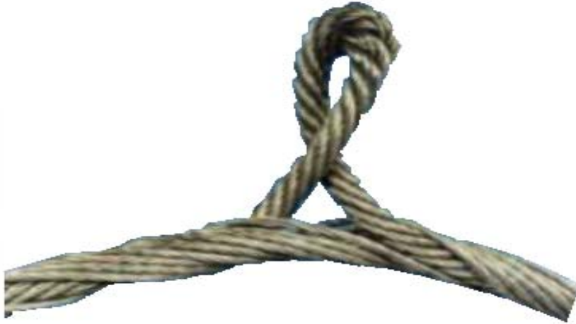
Rys. 14 Niebezpieczne załamanie – zwraca się uwagę na skręcenie liny przyczyniające się do wypadnięcia rdzenia – uzasadnienie natychmiastowej wymiany.
